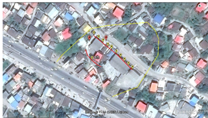
شکل ۱: H1, H2 محل حفر گمانه‌های اکتشافی، sh محل سونداژ قائم الکتریکی و P-1 موقعیت پروفیل توموگرافی الکتریکی، منحنی زرد رنگ هندسی و مرزهای توده لغزشی
