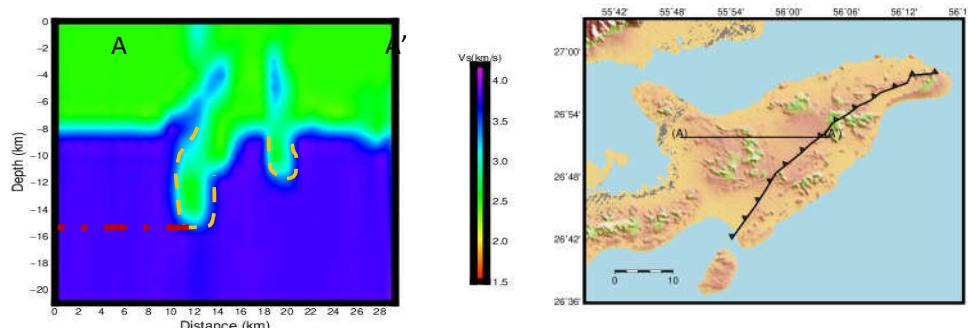
شکل ۲. موقعیت مقطع عمودی 'AA' رسم شده در منطقه برای بررسی گندن نمکی (سمت راست)، مقطع عمودی 'AA' (سمت چپ). خط چین‌های زرد رنگ مشخص کننده محدوده عمقی گندن نمکی در پروفیل و خط چین‌های قرمز نقطه شروع گندن نمکی در پروفیل.
