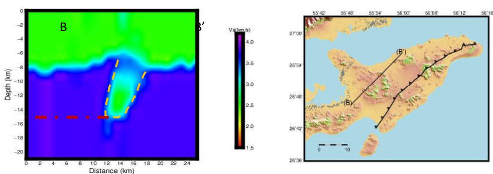
شکل ۳. موقعیت مقطع عمودی 'BB' رسم شده در منطقه برای بررسی گندن نمکی (سمت راست)، مقطع عمودی 'BB' (سمت چپ). خط چین‌های زرد رنگ مشخص کننده محدوده عمقی گندن نمکی در پروفیل و خط چین‌های قرمز نقطه شروع گندن نمکی در پروفیل.
