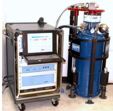
شکل ۴. طرحی از گرانش سنج ابررسانا. (GWR Instruments)
